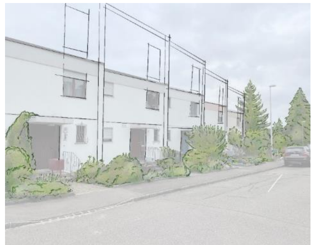
Abbildung 19: Skizze mit verschiedenen Erweiterungsmöglichkeiten in die Höhe an den Beispielen Lerchenstrasse (inkl. Erweiterung oberhalb der Parkfläche).
